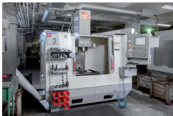
HAAS VF-2 x = 762 mm · y = 406 mm · z = 508 mm
