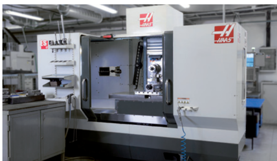
HAAS Automation - ES -5-4AX x = 1016 mm · y = 457 mm · z = 558 mm
