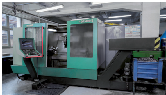
Lathe MAHO GRAZIANO GR 400 E d = 280 mm · l = 400 mm
