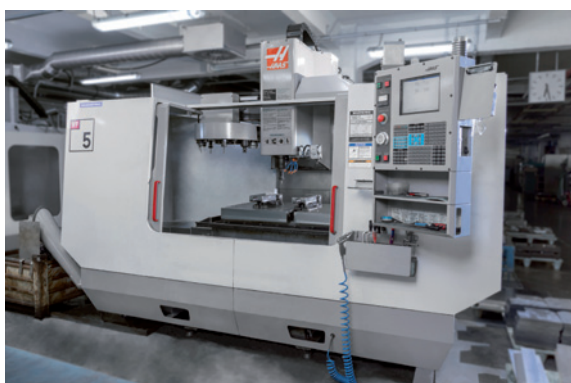
HAAS VF-5 x = 1270 mm · y = 660 mm · z = 635 mm
