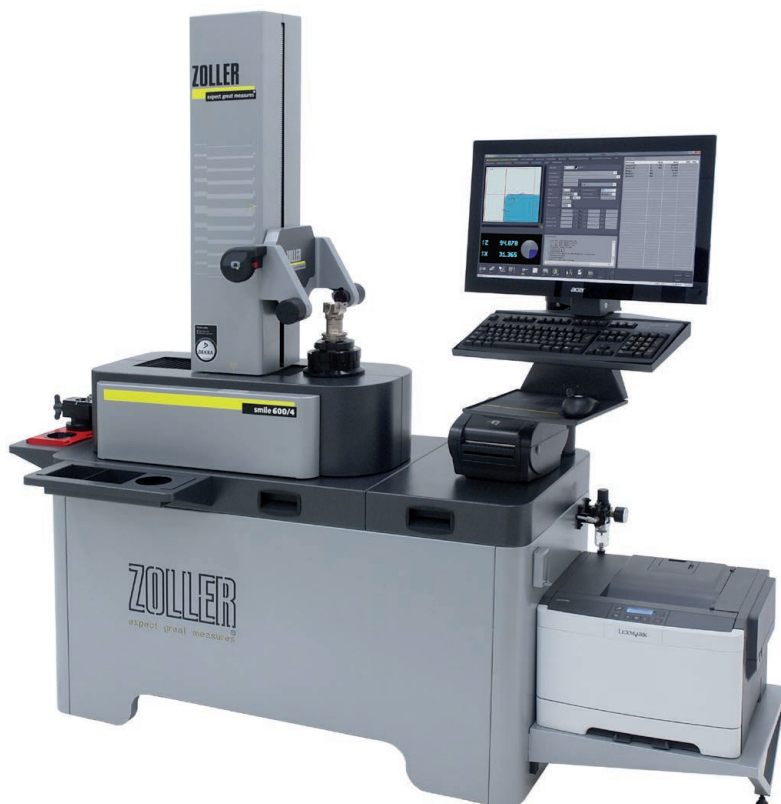
Přístroj »smile 400« s kamerovým zpracováním obrazu ZOLLER »pilot 3.0«
